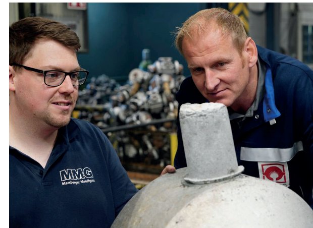
Speiser nach dem Abguss bereit zum Abschlagen
