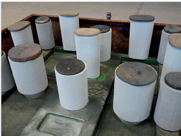
Speiser positioniert im Formkasten
